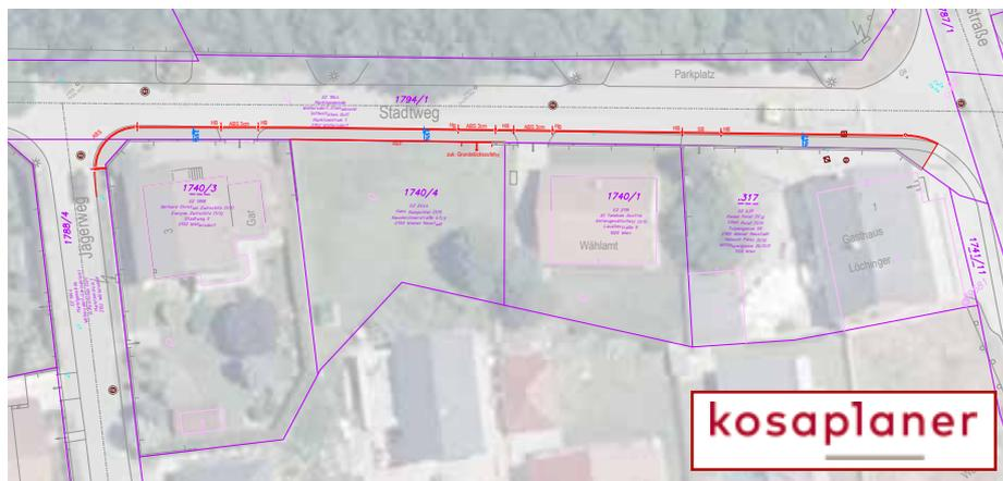
zung mit dem Jägerweg fortführen. Die Verlängerung des Gehsteiges entlang des Stadtweges beträgt ca. 105 m und wird mit einer Breite von mindestens 1,5 m ausgeführt. Die Baukosten für dieses Bauvorhaben belaufen sich auf rund € 23.000,00 inkl. USt..
